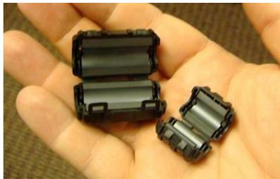
Abbildung 1: Ihre PQube erfüllt alle IEC-Anforderungen für Hochfrequenz-Emissionen und Anfälligkeit, sowohl durchgeführt als auch abgestrahlt. Zum weiteren Schutz können Sie Transom Ferrite auf Signalkabel, Hochfrequenz Emissionen zu minimieren. Das sind z. B. Panasonic KRCBC160928B und KRCBC130714B.
