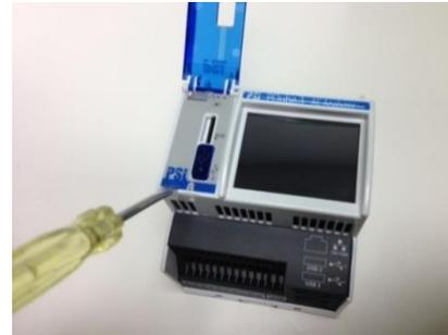
Zum Entfernen und ersetzen Sie die Batterie, legen Sie einen kleinen Wohnung-Schraubendreher Hebeln das Label in der Nähe von den USB-Port und MicroSD-Karten-Slot. Entfernen Sie die alte Batterie und installieren Sie das neue zu. Es ist nicht möglich, den Akku falsch herum zu installieren.
