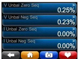
**Unbalance:** Diese Zähler zeigen die Spannungsunsymmetrie und der aktuellen Unwucht. Sie wählen in der Setup.ini -Datei, ob Ihre PQube Unwucht, die mit der ANSI-C84.1-Methode oder die IEC-Methode oder der GB-Methode berechnet.
