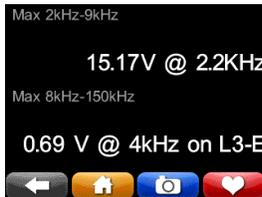
**2-150kHz:** Verwenden Sie dieses an die leitungsgebundene im Bereich von 2-150 kHz. Nützlich für die Überwachung von Lärm durch Interferenz-Quellen, einschließlich solar-Wechselrichter.
