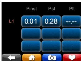
**Flicker:** Diese Zähler anzeigen flackern nach IEC 61000-4-15 Edition 2 Methoden. P<sub>inst</sub> ist der momentane Flimmern-Wert für Kunstlicht flackert. P<sub>st</sub> ist, dass die kurzfristige Flicker, eine statistische Analyse der P<sub>inst</sub> nach 10 Minuten mit Echtzeituhr synchronisiert. P<sub>LT</sub> ist der Mittelwert Pinst über vorherige 2 Stunden, mit Echtzeituhr synchronisiert.
