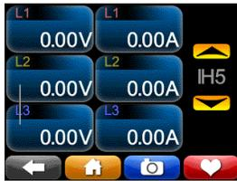
**Interharmonics:** Verwenden Sie dieses zeigen Sie jede Interharmonic bis zu 50th für Spannung und Strom an. Eine harmonische gleichzeitig auswählen. Die ausgewählten Interharmonic gilt für alle Kanäle. (Harmonische Werte bis zu den 63rd werden in CSV-Dateien für Ihre PQube 3 aufgezeichnet.)
