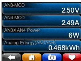
**Analoge Kanäle:** Die analoge Messgeräte zeigen die RMS-Spannung (DC-Spannung für DC-Signalen entspricht). Sie können die Erde-analoge Kanäle (Gemeinsamer Modus) und die Analog-Analog-Kanäle (differential-Modus) anzeigen.
