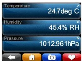
**Umwelt Meter:** Wenn Sie ENV2 Umwelt Sonden haben, können Sie Ihre Temperatur, Luftfeuchtigkeit, Luftdruck, Beschleunigung, Thermoelementeingang und Solarstrahlung Eingang hier anzeigen.
