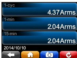
**Peaks:** Diese Zähler zeigen die Spitzenwerte auf Load, Watt und VARS erreicht. Die Peak-Akkumulatoren können zurückgesetzt werden, durch Drücken der Reset-Taste
