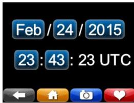
**Datum/Uhrzeit:** Sie können die Zeit und Tag ändern, es sei denn, Sie so konfiguriert sind, dass auf SNTP oder NTP synchronisiert oder Ihre PQube 3 mit GPS verbunden ist.
