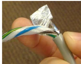
Abbildung 2: Zur Minimierung von Emissionen mit dem optionalen PM1 Power Supply Modul optional verwenden Sie ein geschirmtes macht Dirigent.
