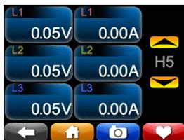
**Harmonics:** Verwenden Sie dieses jede harmonische bis zu 50th für Spannung und Strom anzeigen. Eine harmonische gleichzeitig auswählen. Die ausgewählten harmonische gilt für alle Kanäle. (Harmonische Werte bis zu den 63rd werden in CSV-Dateien für Ihre PQube 3 aufgezeichnet.)
