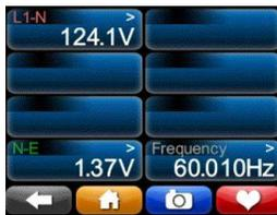
**Spannung und Frequenz:** Dies sind die Zeile um Zeile, Linie-Neutral und Neutral gegen True-RMS-Voltmeter. Verschiedenen Messgeräte zeigt auf diesen Bildschirmen, abhängig von Ihrer Konfiguration macht. (Z. B. wenn die Energiekonfiguration "Delta" ist, es werden keine L-N-Meter, da kein Neutralleiter vorhanden ist.) Wenn Sie eine potenziellen Transformator-Verhältnis in der **Setup.ini** -Datei festgelegt haben, spiegeln die Werte dieses Verhältnis.
