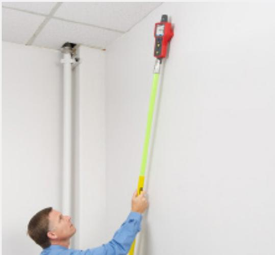
Aufspüren von Leitungen in schwer zugänglichen Bereichen mithilfe eines isolierten Verlängerungsstabs.
