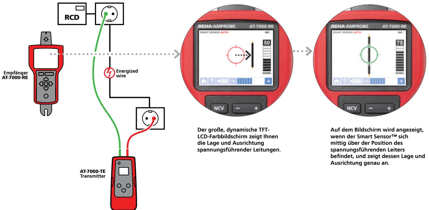
Der große, dynamische TFT-LCD-Farbbildschirm zeigt Ihnen die Lage und Ausrichtung spannungsführender Leitungen.
