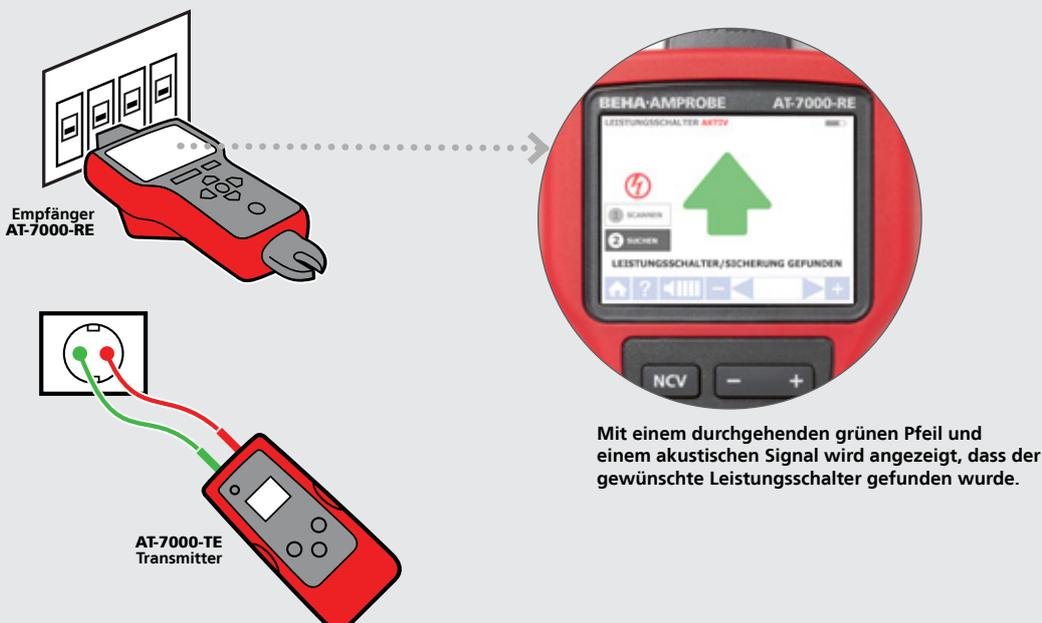
Mit einem durchgehenden grünen Pfeil und einem akustischen Signal wird angezeigt, dass der gewünschte Leistungsschalter gefunden wurde.
