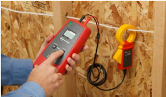
Induzieren des Signals mit der Stromzange, wenn nur isolierte Leiter vorhanden sind.
