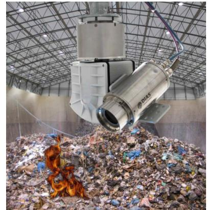
Die speziell für die Brandfrüherkennung entwickelte Hard- und Software ist in der Lage entstehende Brände im Frühstadium zu erkennen um mit wenig Löschmitteleinsatz zielgerichtet den noch kleinen Brandherd zu bekämpfen. Eine Kopplung des mit Infrarotkameras aufgebauten Systems mit einer Sprinkleranlage oder einem Löschwasserwerfer ist kein Problem, somit kann der Brand nach Bedarf auch vollautomatisch ohne Personaleinsatz gelöscht werden.
