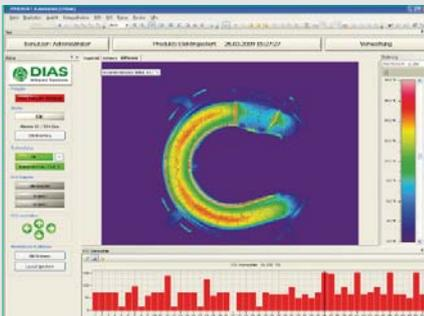
Für die Integration von Infrarotkameras in Automatisierungsprozesse hat DIAS die Software-Lösung PYROSOFT Automation entwickelt:
