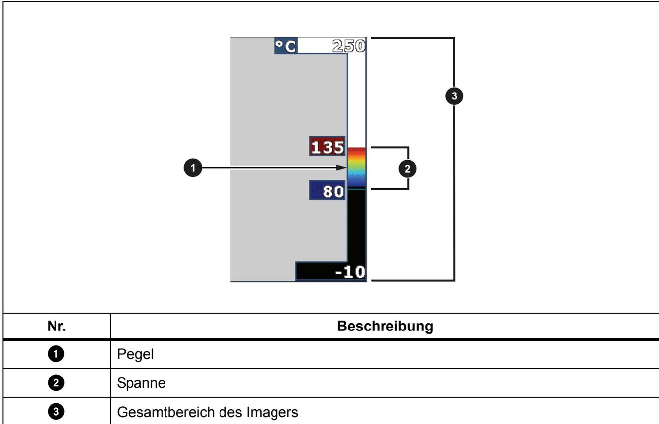
Befinden sich Pegel/Spanne im automatischen Modus, stellt der Imager **Pegel/Spanne** anhand der in **Bereich** festgelegten Temperaturen ein.
