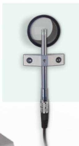
Direkte Montage des SS 20.400 vor der Wandöffnung zur Erfassung der Überströmungsgeschwindigkeit.
