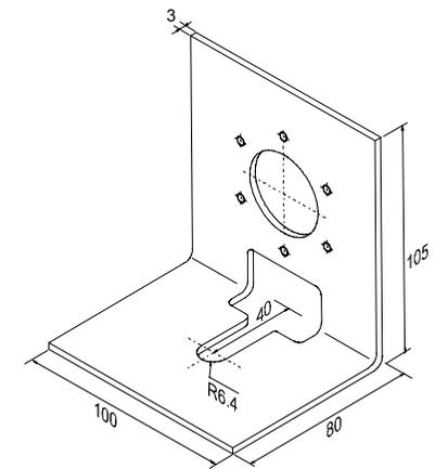
Maßzeichnung mit Luftblasvorsatz, Montagewinkel und Keramikrohr
