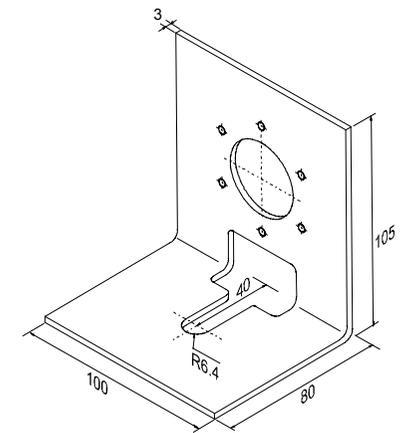
Maßzeichnung mit Luftblasvorsatz, Montagewinkel und Inconelrohr
