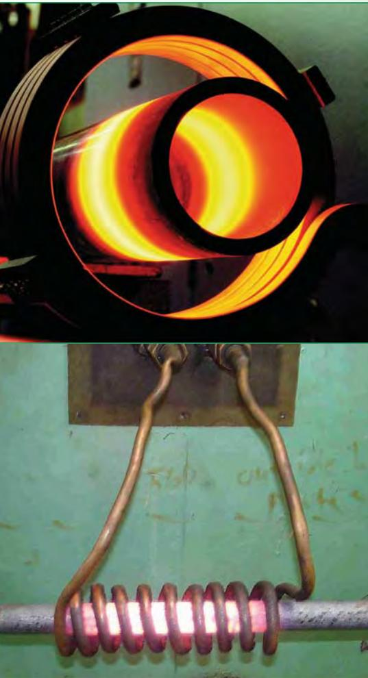
Das induktive Härten ist ein Verfahren zur Oberflächenhärtung, vor allem eingesetzt bei kompliziert geformten Werkstücken, Teilen oder zur partiellen Härtung von bestimmten Bereichen eines Werkstückes. Einer der wichtigsten Parameter beim Induktionshärten ist die richtige Temperatur des Teiles, um die geforderte Produktqualität zu gewährleisten. Diese liegt je nach Werkstoff bei ca. 900 °C.
