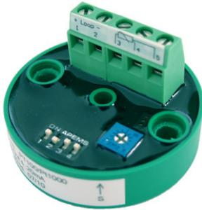
Der LKM113 ist ein digitaler konfigurierbarer Messumformer für Pt100/Pt1000 mit 4..20mA Stromausgang. Über 4 Jumper können 12 verschiedene Messbereiche eingestellt werden. Kleinere Korrekturen können mittels Nullpunktregler vor Ort durchgeführt werden. Der Anschluss des Sensors erfolgt in 3/2-Leiterschaltung.
