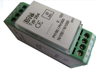
Der LKM 264 ist ein digitaler programmierbarer Messumformer für Widerstandssensoren mit 0..10V Spannungsausgang zur Montage auf 35mm-Hutschiene. Mittels PC und Programmierkabel können Sensortyp, Messbereich und Schaltungsart festgelegt werden. Kleinere Korrekturen können mittels Nullpunktregler durchgeführt werden. Der Anschluss des Sensors erfolgt in 2L-, 3L- bzw. 4-Leiterschaltung.
