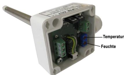
Im Gehäuse des Messumformers befindet sich zwei Einstellregler mit dem eine Korrektur des Ausgangssignals vorgenommen werden kann. Dieses ist zum Beispiel notwendig, wenn eine Temperatur- oder Feuchtedifferenz zwischen dem Messpunkt und dem zu regelnden Punkt besteht. Der Regler ist gegen versehentliches Verstellen gesichert. Der Verstellbereich beträgt ca.  $\pm 5K$  bzw.  $\pm 5\%r.H.$
