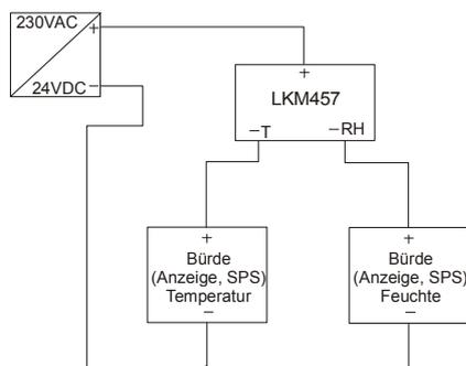
Die Signale des Sensors LKM 457 werden von einem Halbleitersensor erzeugt und digital an einen Mikroprozessor übertragen, verarbeitet und dann analog als Stromsignal wieder ausgegeben. Der Ausgangsstrom folgt dabei linear dem am Eingang anliegendem Signal. Für Korrekturen von Messfehlern kann der jeweilige Nullpunkt-Regler verstellt werden.
