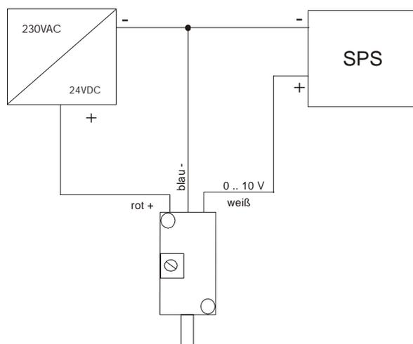
Die Ausgangsspannung folgt dem am Eingang anliegenden Temperatursignal. Zwischen dem Sensor und der Versorgungs- bzw. Ausgangsspannung darf keine galvanische Verbindung bestehen.
