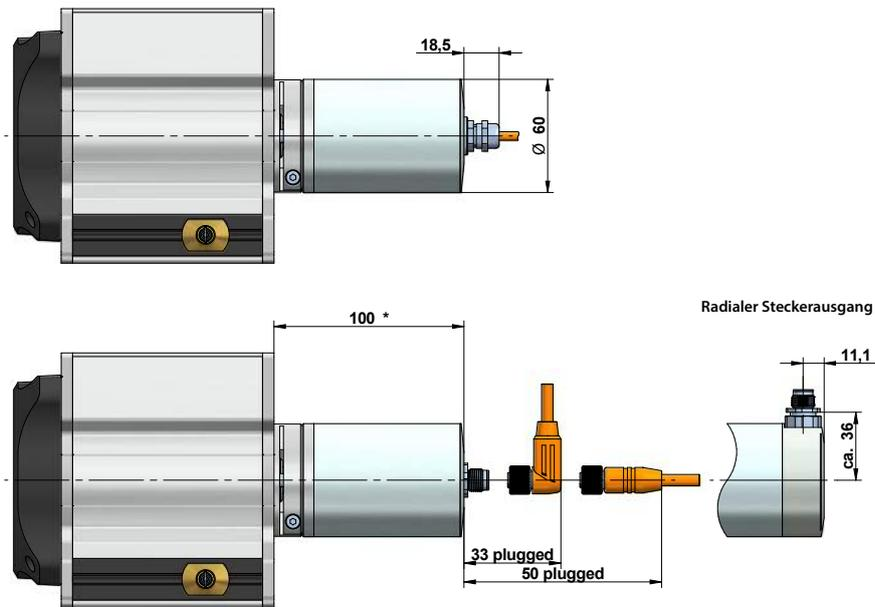
\* Ab einem Messbereich von 30 m und bei radialem Steckeranschluss beträgt die Encoderlänge 120 mm statt 100 mm.
