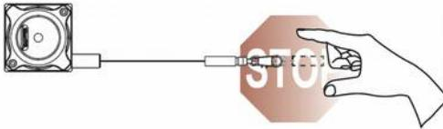
Beachten Sie bei der Handhabung des Sensors, das Seil nicht versehentlich schnappen zu lassen oder das Seil über den spezifizierten Messbereich ausziehen. Dadurch kann der Sensor zerstört werden.
