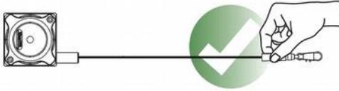
Das Seil muss im Betrieb senkrecht aus dem Sensor ausgezogen werden.
