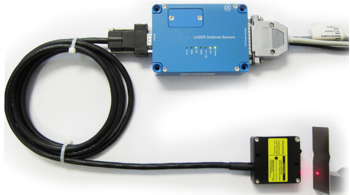
Optisches Messsystem bestehend aus Sensorkopf, Sensorkopfkabel und Elektronik-Einheit
