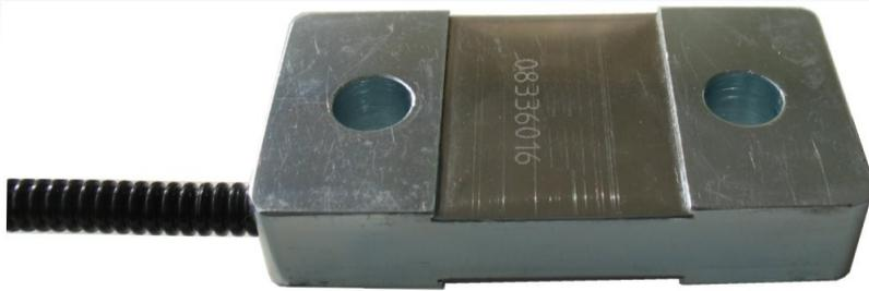
Der Dehnungsaufnehmer DA70 eignet sich zur Dehnungs- und Kraftmessung an Maschinenelementen in rauher Umgebung. Die Installation erfolgt durch Anschrauben des Aufnehmers mit 2 Schrauben M10 auf einer ebenen Werkstoffoberfläche. Das Anschlusskabel ist wahlweise als PUR Kabel ausgeführt oder mit einem zusätzlichen Wellschlauch geschützt.
