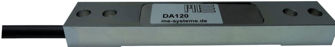
Der Dehnungsaufnehmer DA120 eignet sich durch seine geschlossene Bauform für die Dehnungs- und Kraftmessung an Maschinenelementen und -Bauteilen in rauher Umgebung.
