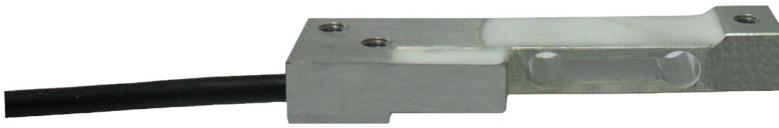
Der Miniatur Kraftsensor KD39 eignet sich mit nur 6mm Höhe und 12mm Breite besonders für die Integration in flachen Messplattformen. In flachen Messplattformen tragen drei Stück KD39 eine Messplatte.
