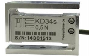
Der Kraftsensor KD34s wurde speziell zur Messung kleinster Kräfte ausgelegt. Durch den integrierten Anschlag gegen Überlast ist dieser Kraftsensor auch im Messbereich 0.25N und 0.5N noch sicher in der Handhabung. In der Ausführung für 0.25N werden spezielle Dehnungsmessstreifen aus einer Platin-Nickel Legierung eingesetzt mit einer um den Faktor 2 höheren Empfindlichkeit gegenüber herkömmlichen Dehnungsmessstreifen aus Konstantan.
