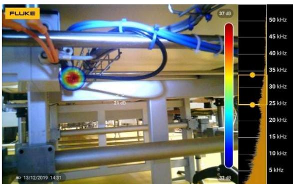
Das grosse, helle Display zeigt die entsprechenden Schallquellen mit vom Benutzer wählbarer Farbskala wie blau-rot, Eisenbogen oder in Graustufen an. Ein Tragegurt erleichtert die Arbeit und sorgt für Sicherheit. Gespeichert werden Dateien als JPG, PNG und MP4 Videos. Das LeakQ Dateiformat ermöglicht zudem die einfache und schnelle Berichterstellung mittels Web-App inklusive Leckbewertung, Distanzangabe zum Leck sowie den Verlust in l/min und CHF sowie kg CO<sub>2</sub> / Jahr als PDF-Datei.
