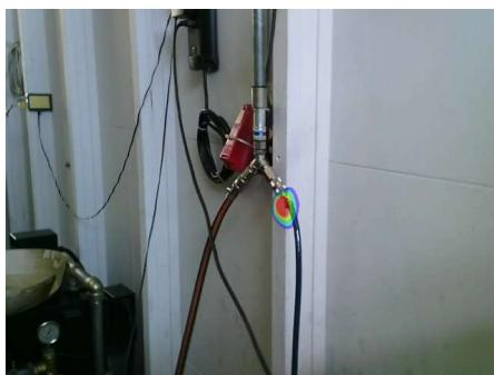
Das helle Display zeigt die entsprechenden Leckagen bzw. Schallquellen mittels Einfärbung blau-rot an. Gespeichert werden Bilder als JPG-Datei, diese können in der im Lieferumfang kostenlosen und lizenziert nutzbaren Software AnalyzIR einfach und schnell als kundenspezifischer Bericht ausgegeben werden, die Datenübertragung erfolgt per USB Kabel oder der enthaltenen micro-SD-Karte vom Gerät zum PC.
