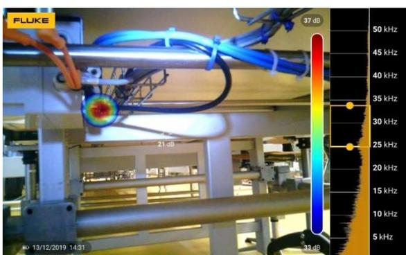
Die Messung und Visualisierung von Schall mit einer Schallkamera erschliesst neue Anwendungsgebiete. Die Leckortung an Druckluft-, Gas- und Dampfleitungen ist nur ein kleiner Teil des Potentials hinter dieser spannenden Technologie. Wir werden uns in diesem Zusammenhang weiteren Anwendungsgebieten widmen und diese in kommenden Beiträgen vorstellen - bleiben Sie dran!
