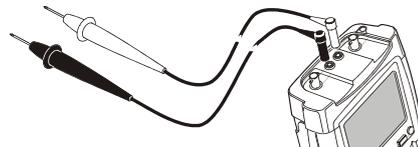
**Abbildung 54. Manuelles Abtasten für Meter-Messungen mittels 2-mm-Prüfspitzen**
