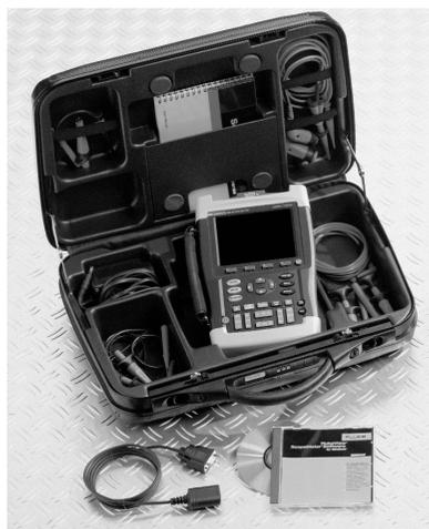
Neben dem mitgelieferten Zubehör bietet Fluke vielseitiges Zubehör an, das den Einsatzbereich der ScopeMeter noch erweitert. Hierzu gehören Stromzangen, Tastköpfe, Temperaturfühler, Messleitungen und Messspitzen. Informationen hierzu erhalten Sie von Fluke Vertriebspartnern oder auf den Fluke Internetseiten.
